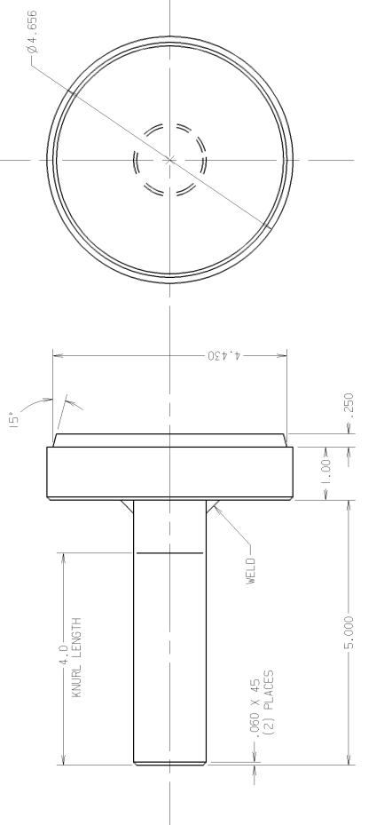
FRONT OUTPUT BEARING CUP DRIVER MILD STEEL
